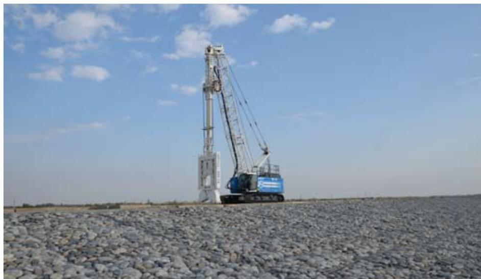
Uzbekistan/Soilmec SC-70 nella nuova livrea blu al lavoro in configurazione con benna idraulica GH-12 per la realizzazione di muri diaframma.
