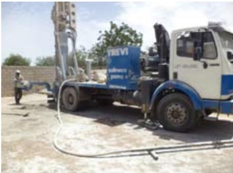
Nelle foto, sopra e a fianco, l’unità di trivellazione in azione per la perforazione di un pozzo, sotto, l’unità mobile di trivellazione Drillmec G8.
