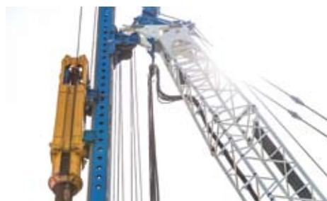
La Soilmec SC-90HD equipaggiata con il nuovo kit per l'infissione dei pali permette l'infissione del palo sfruttando diversi angoli d'inclinazione.
