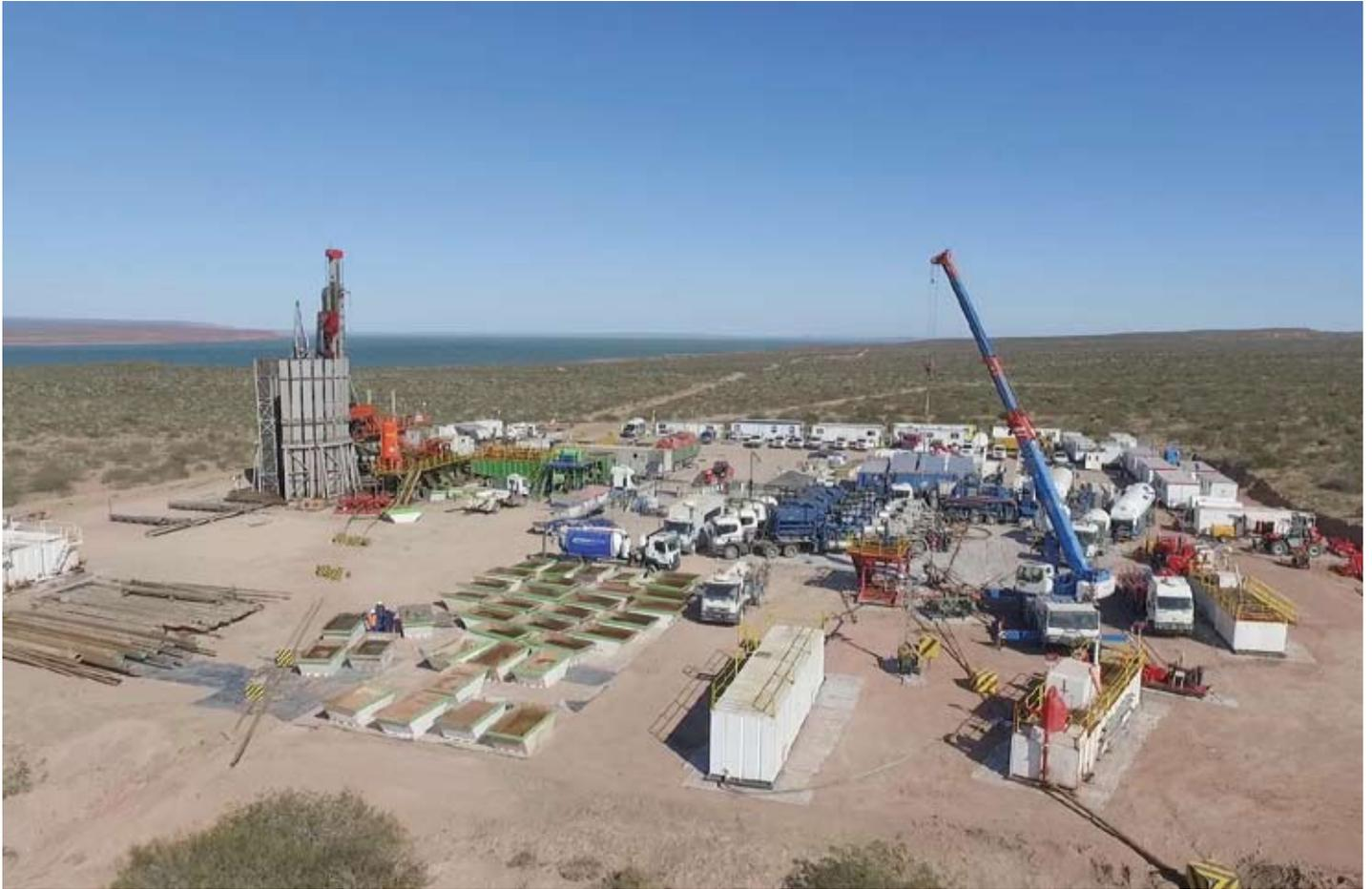
Utilizzando un drone per riprese aeree è stato possibile scattare queste suggestive fotografie del campo di perforazione Loma de Lata (provincia di Neuquen) del cliente YPF Gas. Le immagini ritraggono operazioni simultanee di perforazione e *fracking*, e sottolineano la flessibilità dei nostri impianti. In particolare, sta operando l'impianto Petreven H-203 che utilizza un modello Drillmec HH-220.
